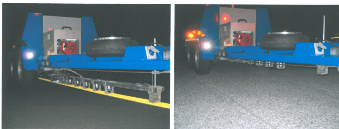
Figura 4. Apparecchiatura HWD utilizzata per il rilievo presso l'Aeroporto V.Bellini di Catania
