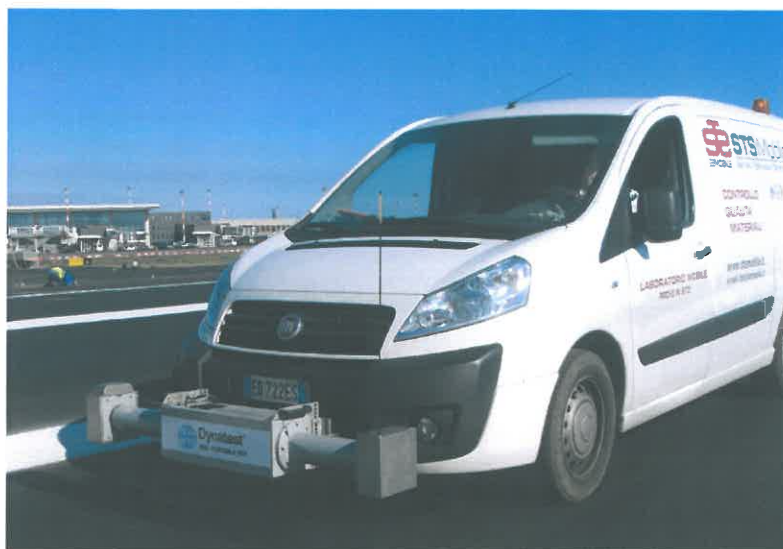
Figura 5. Profilometro RSP Mark IV utilizzato per i rilievi delle caratteristiche superficiali
